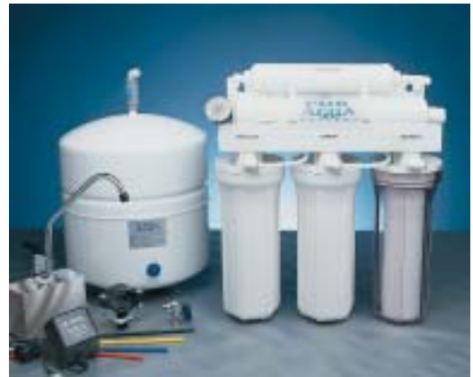
Equip d'òsmosi inversa en 5 etapes, un sistema d'autorentat de la membrana i un tanc pressuritzat de 10 litres. Els nivells de reducció que s'assoleixen quant a minerals és del 90 % i el TDS (Total Sòlids Dissolts) pot ser de menys de 100 ppm, és a dir, inferior a algunes aigües minerals.
